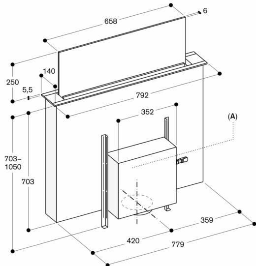
A: Flexible Montage der Lüftereinheit auf der Vorderseite, auf der Rückseite oder mit Abstand vom Gerät (Montageset erforderlich – max. Abstand 3 m)
